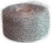
**Стальной фетр, стальная канитель**, - материал состоящий из тонких стальных нитей, напоминающий по структуре сахарную вату. Изготавливается из разных видов стали, в том числе из нержавеющей. Используется для располировки густых и жидких восков, полиролей на основе воска и силикона.
