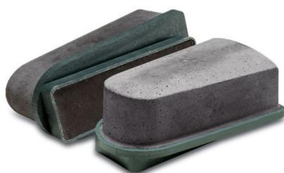
**Fickert 140 (Фикерт 140)** - Сегмент с креплением в виде трапеции «ласточкин хвост». Приблизительные размеры основания . Изготавливаются для шлифовки гранита на полировальных линиях, устанавливаются на специальную полировальную головку. Размеры крепления приблизительно: 40-48x125 мм.
