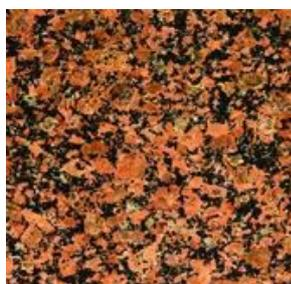
**Гранит** - для целей обработки это все камни так или иначе связанные с вулканической деятельностью и магматическим происхождением - гранит, лабрадорит, габбро, диабаз, амфиболит иногда базальт, кварцит. Обрабатывается инструментом по граниту, клеится эпоксидным клеем.
