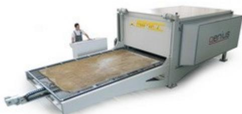
**Резинатура** - «resinatura» - армирование каменных плит при помощи сетки и полиэфирного клея с тыльной стороны. Производится для укрепления плит и заполнения пор. Для придания хорошего товарного вида плита покрывается клеем также с лицевой стороны и полируется.
