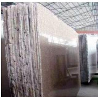
**Сляб, слэб, слэб** - плита, «лист» из камня, заготовка для дальнейшего производства изделий. Добытые каменные блоки распиливают на «листы» толщиной 20 или 30 мм. Каменный «лист» с одной стороны шлифуется и полируется, а с другой проклеивается специальной защитной сеткой, торцы «листа» остаются не обработанными.
