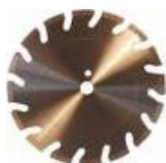
**Диск "Сегмент" с широким пазом** - (условное деление) алмазный отрезной сегментный круг в котором расстояние между сегментами больше 5 мм. Дает сравнительно высокую скорость резания в ущерб качеству кромки.
