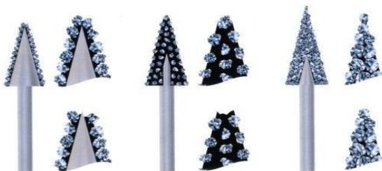
с алмазными зёрнами. Изготавливаются самых различных форм и размеров. Технологии изготовления: гальваническое напыление, спекание, вакуумно-диффузионная сварка.
