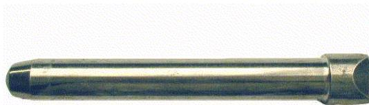
**Закольник** - стальной инструмент, рабочая часть которого заточена с одной или двух сторон под углом 65°. Закольники бывают одноручные и двуручные. Одноручный закольник
