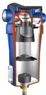
**Сепаратор, влагоотделитель** - устройство в виде колбы, устанавливаемое в пневматическую систему для отделения капель влаги от воздуха. Внутри колбы находятся специальные лепестки которые
