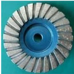
**Фреза алмазная торцевая, ФАТ** - вид алмазного круга у которого рабочая поверхность находится на плоскости с одной стороны. С другой стороны находится крепеж. Режущим элементом является алмазные зерна которые закреплены в металлической связке.
