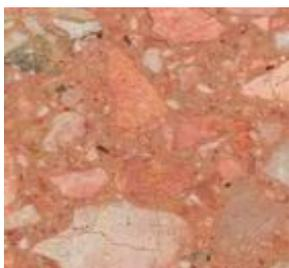
**Агломерат, конгломерат** - все что изготовлено путем скрепления кусков натурального камня различными связующими веществами. Метод обработки агломерата определяется тем, какого материала в нем содержится большая доля. Классические примеры: Quarella, Santa-Margherita.
