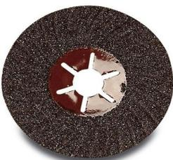
**ЗЕС-диск** - абразивный шлифовальный диск с отверстием. Название получил от фирмы-производителя ZEC s.p.a. (Италия). Абразивное зерно закреплено на прочном картоне. Форма диска слегка выгнутая, куполообразная. Работает без водяного охлаждения.
