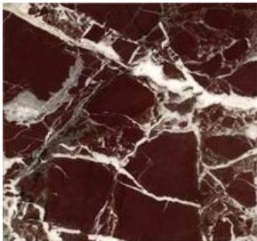
**Мрамор** - для целей обработки это все камни так или иначе связанные с кальцием и метаморфическим происхождением - мрамор, травертин, доломит, доломитизированный известняк. Обрабатывается инструментом по мрамору, клеится полиэфирным и эпоксидным клеем.
