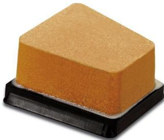
**Frankfurt (Франкфурт)** - Сегмент с креплением в виде трапеции «ласточкин хвост». Приблизительные размеры основания . Изготавливаются для шлифовки гранита, мрамора, бетона на коленно-рычажных станках и на машинах типа «Акилли» (Achilli). Размеры крепления приблизительно: 80-115x115 мм.
