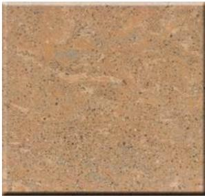
**Керамогранит, грес, gres, керамический гранит** - это современный искусственный материал, выпускаемый в форме плит (плитки). Был разработан и начал внедряться в производство в 80-х годах прошлого столетия. Исходным материалом для производства керамогранита служит каолиновая глина. Производство керамогранита состоит из четырех стадий: замес, прессование, обжиг и обработка поверхности (шлифовка, обработка "под антику"). Обрабатывается инструментом по керамограниту, клеится эпоксидным клеем.
