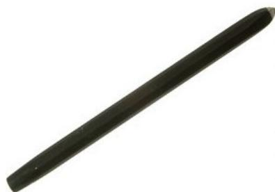
**Шпунт** - это круглый или граненый стальной стержень, заостренный с одного конца. Угол заострения для твердых пород камня составляет  $70^\circ$ , для среднетвердых -  $20^\circ$ . Изготавливают шпунты из углеродистой или легированной стали. Улучшенные шпунты снабжены на рабочем конце штифтом из твердого сплава.
