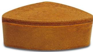
**Cassani (Кассани)** - Сегмент ромбовидной формы со специальным креплением (упорный ободок с одной стороны основания). Предназначены для шлифовки мрамора на машинах типа «Акилли» (Achilli). Размеры приблизительно: 116x60 мм.
