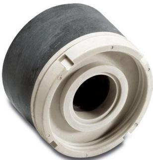
**Rullo (Рулло) «Роллер»** - Сегменты в виде цилиндра для планетарной головки для шлифовки гранита на коленно-рычажных станках и машинах типа «Акилли» (Achilli). Размеры приблизительно: 100x70 мм, Бывают с резьбовым креплением и с креплением Terzago (Терцаго).
